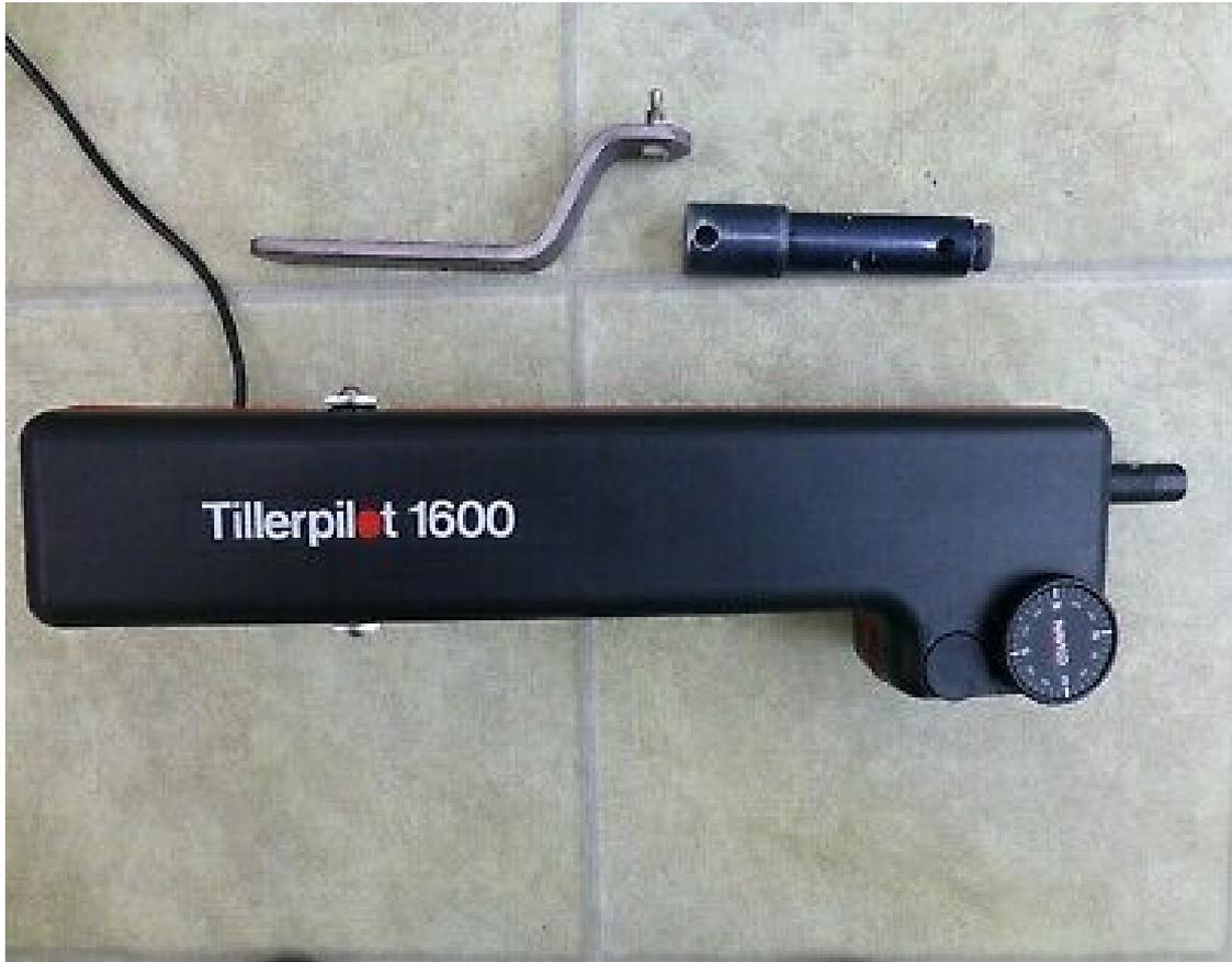
Les pilotes Navico Tilleperpilot sont équipés d'un cadran de compas et de deux commandes de base : un commutateur de mode/ratio de barre et un bouton d'état de mer variable.
